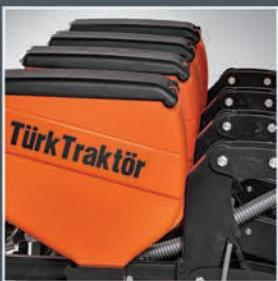
Parallelogram tipi bağlantı sistemi güçlündür. Merkezinde bulunan baskı yayının farklı pozisyonları ile toprağa uygulanan basınç kolaylıkla ayarlanır.
