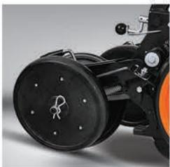
Balta tip çizi açıcılar istenilen derinlikte çizi açarak tohumun ekilmesi için uygun ortamı sağlar.
