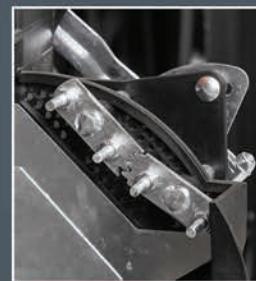
Farklı tohumların ekimi için çeşitli ekim diskleri bulunmaktadır. Kolay ayarlanabilen özel tasarımlı sıyrıcı mekanizması ile disk üzerindeki deliklerde birden fazla tohum bulunmaz.
